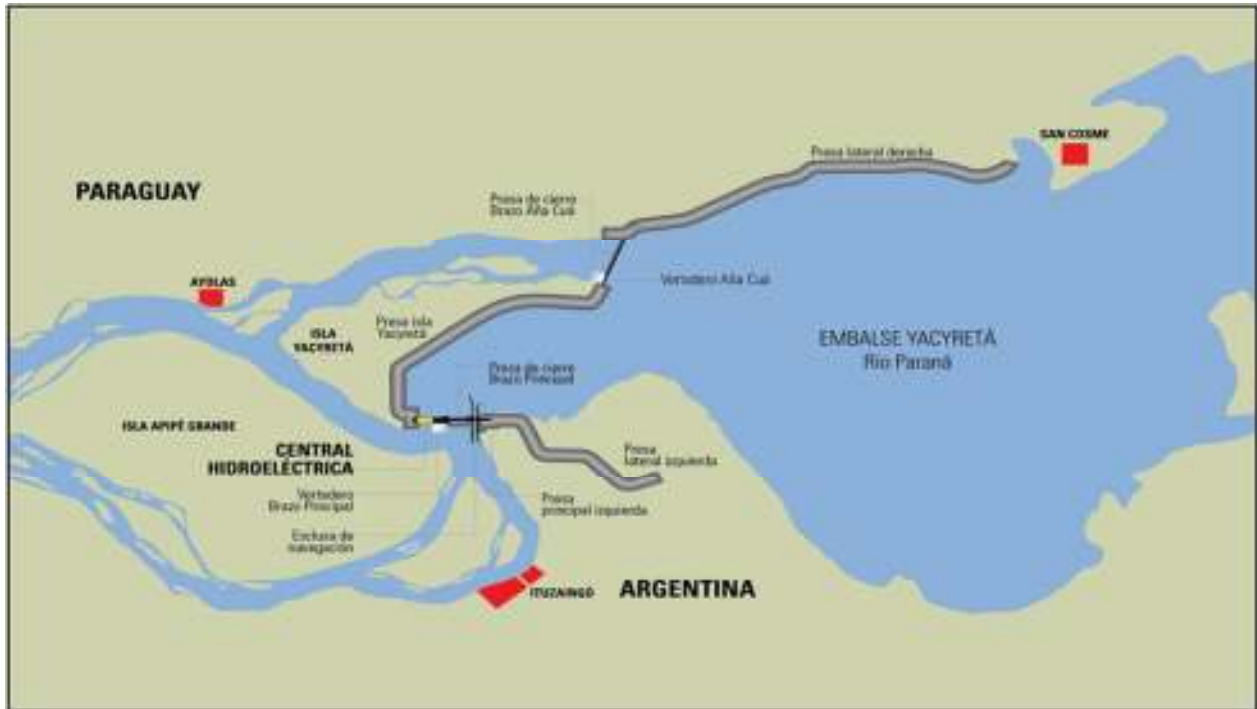
Figura 4. Detalle del cierre físico de la Represa Hidroeléctrica Yacyretá.
