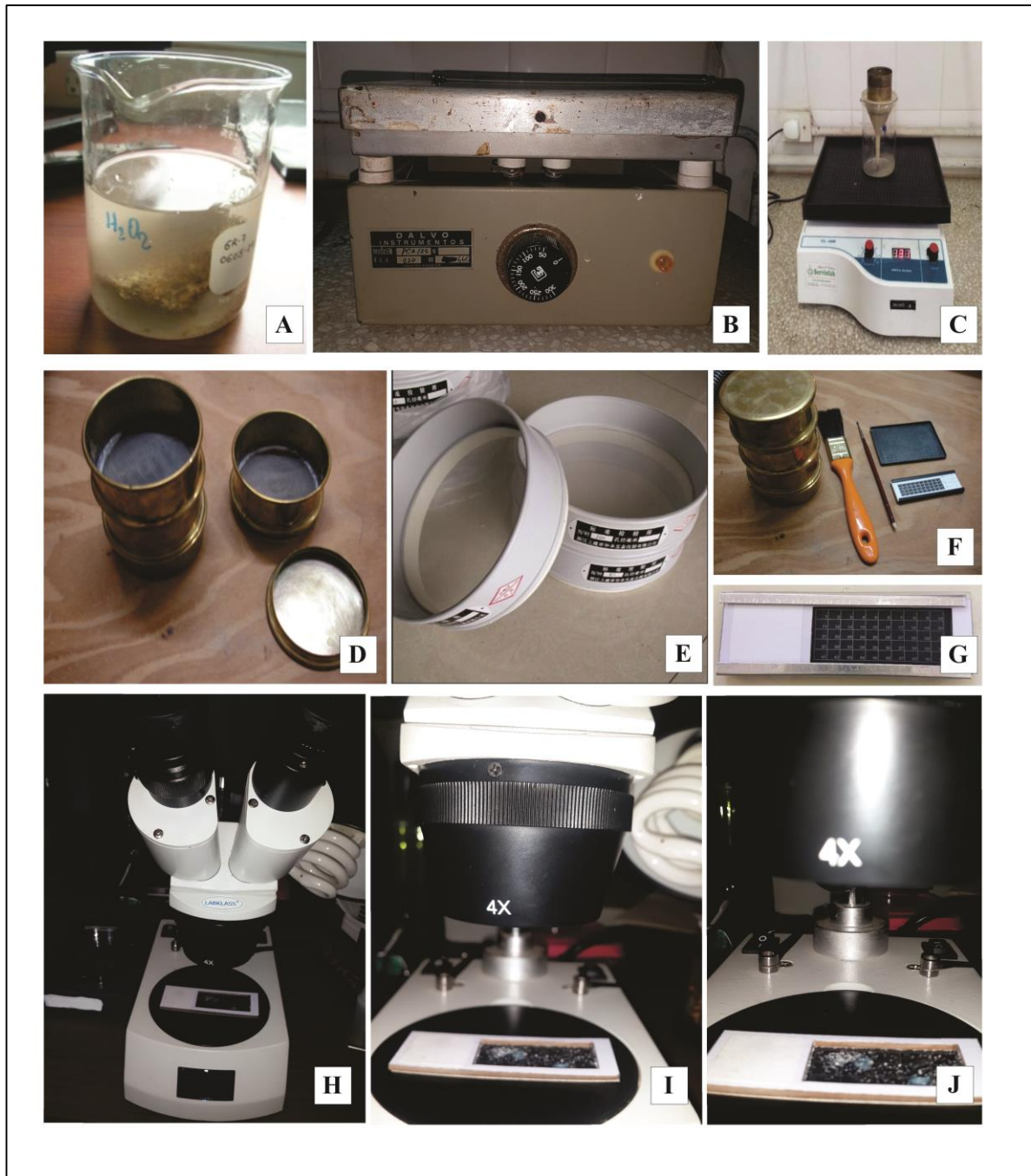
Lámina 2: Materiales utilizados en el trabajo de laboratorio. A: Método del agua oxigenada. B: Plancha termostática. C: Shake. D-E: Tamices. F-G: Pinceles y portamicrofósiles. H-J: Lupa estereoscópica, portamicrofósiles, picking (Fuente propia).
