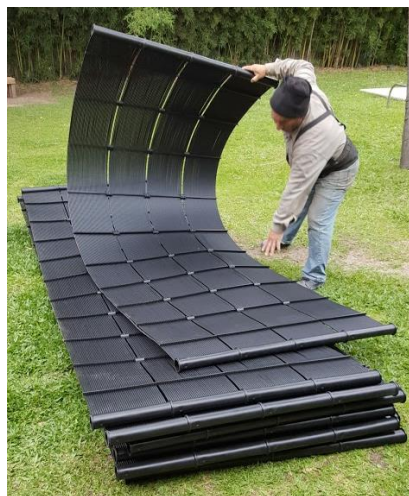
Fig. 5.11. Paneles calentadores de agua (Fuente: visita a obra en la ciudad de Corrientes)
