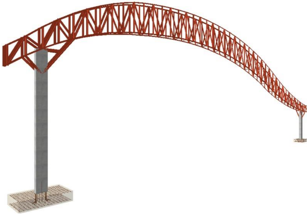
Fig. 6.3. Esquema de la cercha obtenido mediante Cype 3D (Fuente: Cype 3D)
