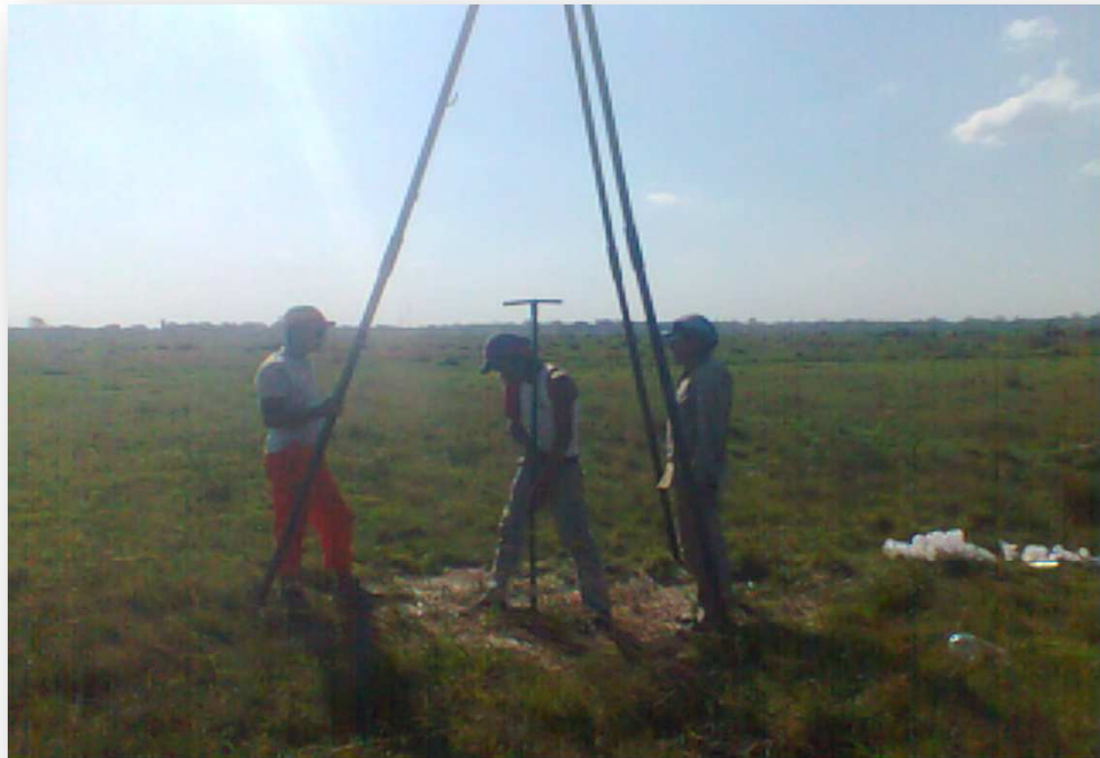
Tareas de perforación y extracción de muestras
