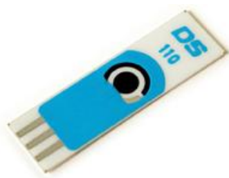
Fig. IX-4: Electrodo serigrafiado comercial, elaborado por Dropsens®.
