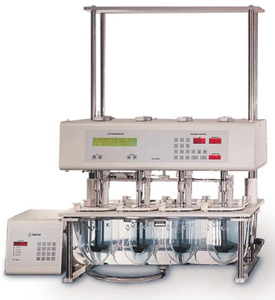
Fig. III-5: Disolutor Varian, modelo VK 7000, utilizado en las experiencias.
