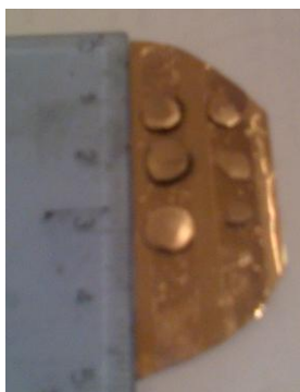
Fig. XI-5: Electrodos recubiertos con oro, sobre una placa de aluminio. La superficie superior, recubierta en oro, es la que se observó por MEB.
