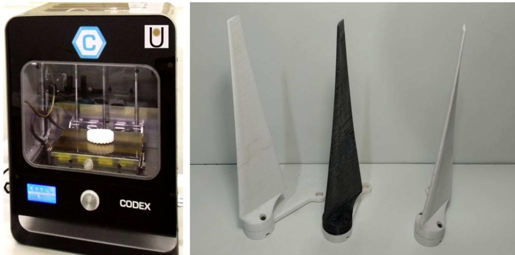
*Figura 3: Impresora 3D de la Facultad de ingeniería y palas del modelo impresas.*
