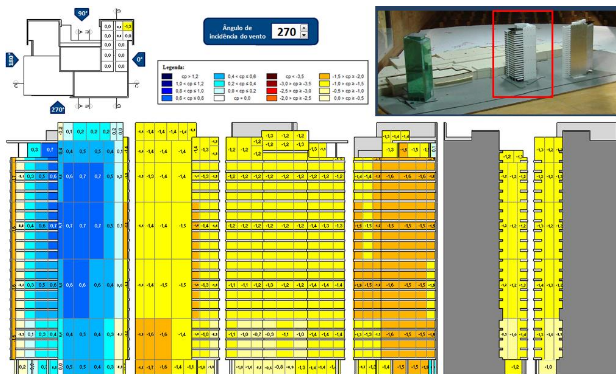
Figura 7. Diagramas de pressões médias nas fachadas do prédio em destaque, obtidos em ensaios em túnel de vento de camada limite (sucção = amarelo, laranja; sobrepressão = azul).
