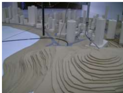
Figura 5. Montaje del modelo para la dirección de viento correspondiente a 345^\circ .
