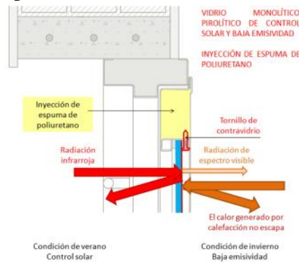
Figura 17: Marco de chapa plegada con inyección de espuma de poliuretano, y vidrio pirrolítico.
