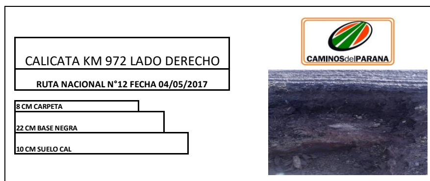
Figuras 3.2 – Datos de calicatas (2017) – Fuente: Caminos del Paraná SA
