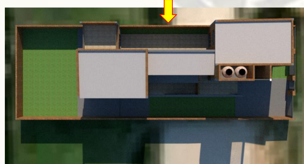
DE MEDIODÍA: Por horas del mediodía la incidencia se da sobre una de las medianeras que se ubica orientada al Norte.
