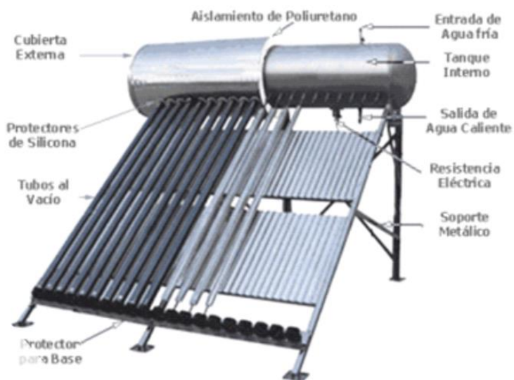
Modelo SD G2 20 200 litros 20 tubos de 1800x58 mm
