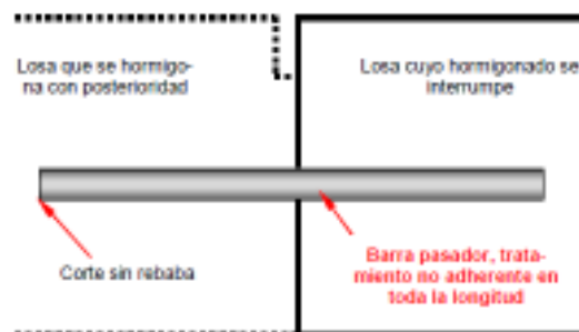
Figura 54. Junta trasversal de construcción (fuente: transportes III universidad nacional de Rosario).
