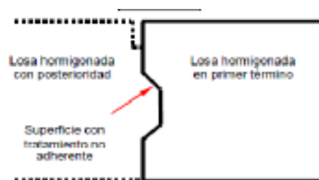
Figura 52. Juntas longitudinales ensambladas a borde libre (fuente: transportes III Universidad Nacional de Rosario).
