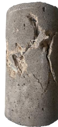
Fig. 2.8 - Modo de falla de HRF (Elaboración propia, 2024)
