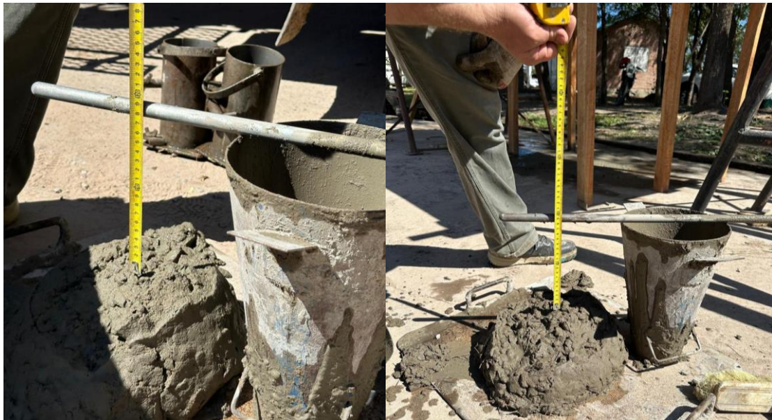
Fig. 2.6 - Medición del asentamiento. Izq: Hormigón sin refuerzo, Der: HRF - (Elab. propia, 2024).
