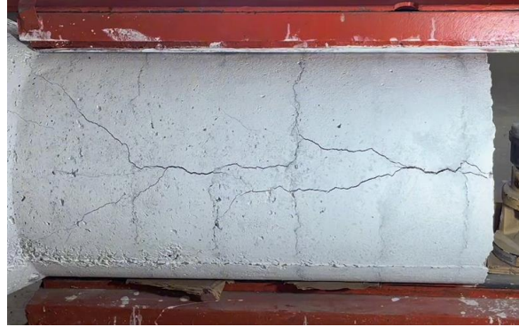
Fig 3.27 - Modo de rotura (40 - 4,5 - 100 - A)
