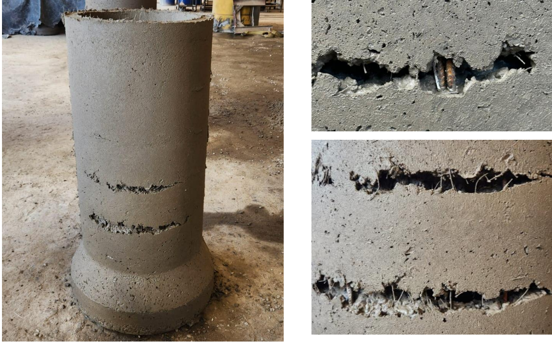
Fig. 3.17 - Formación de fisuras por asentamiento plástico en 40-4,5-100-A.
