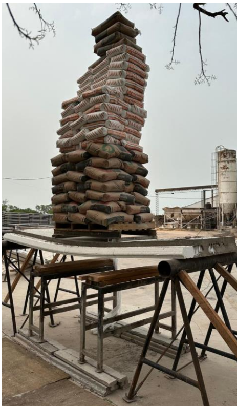
Fig. 2.23 Carga máxima forjado N°1 (3317 kg)
