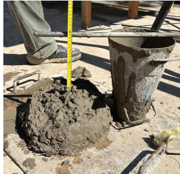
Fig. 1.13 - Medición del asentamiento por el cono de Abrams. (Hormigones Melmix)
