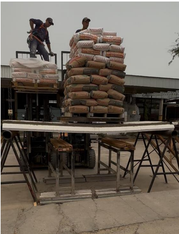
Fig. 2.26. Carga máxima Forjado N°2 (2467 kg)
