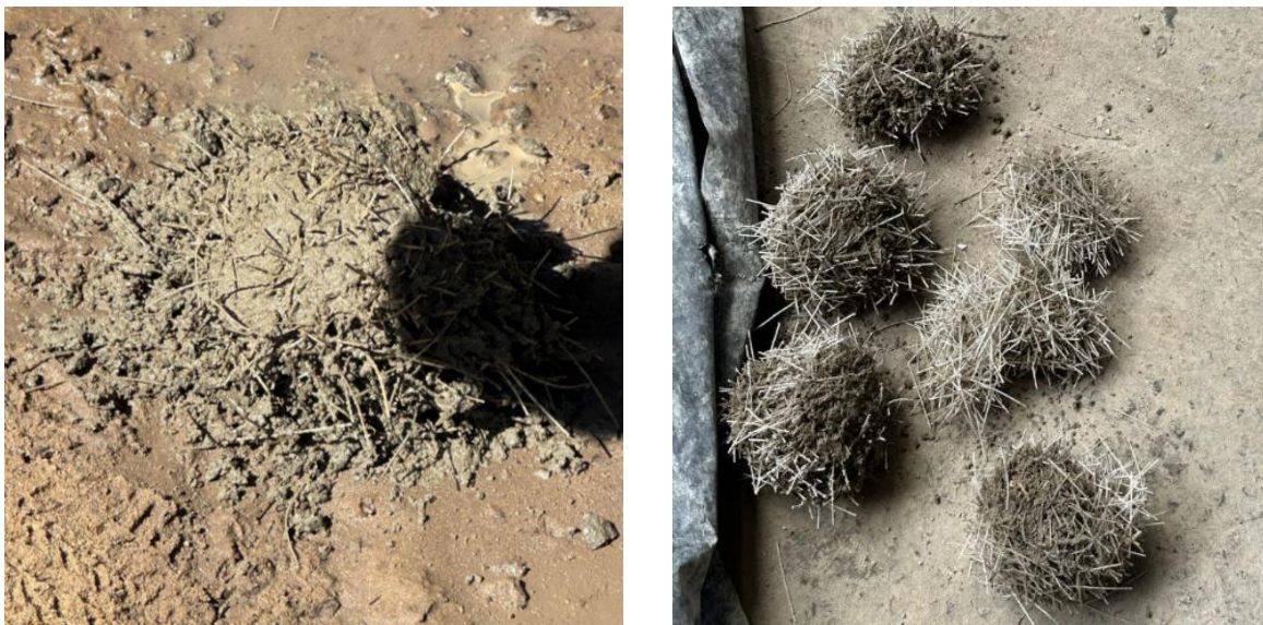
Fig. 1.11 - Formación de “erizos” en la mezcla (Elaboración propia, 2024)
