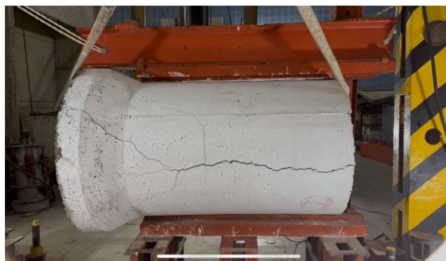
Fig 3.35 - Modo de rotura (60 - 6 - 120 - A)
