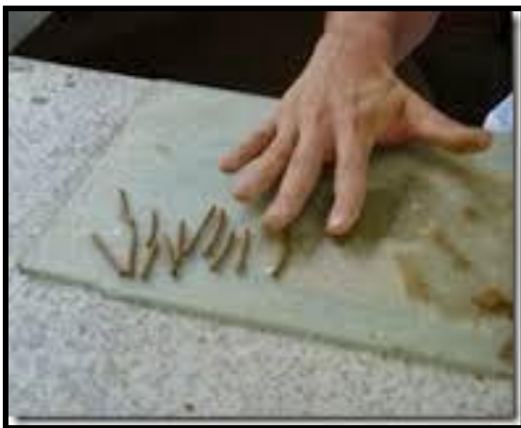
Imagen 20. Cilindros de suelo para el ensayo del límite plástico
