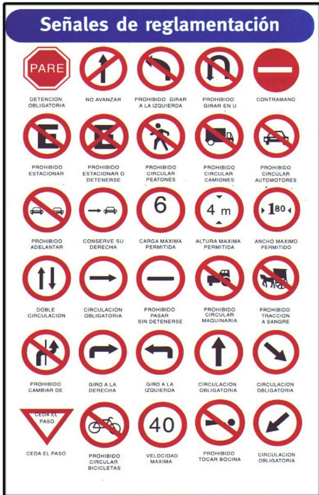
Imagen 61. Señales de reglamentación (DVP Corrientes)
