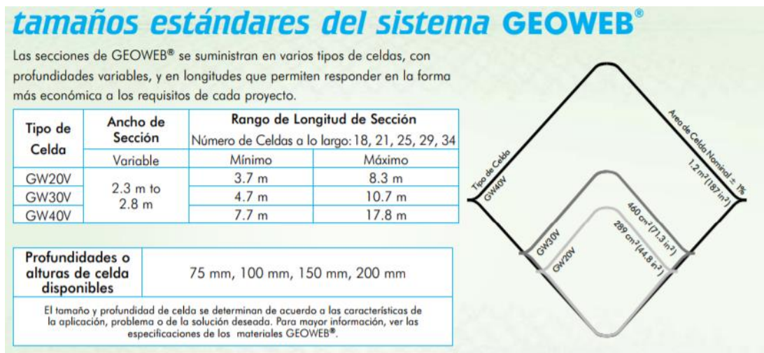
Figura VI-42. Características técnicas de las geoceldas comerciales (fuente: catálogo Coripa S.A)
