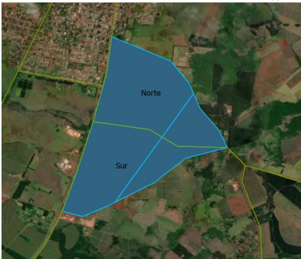
Figura 25. Aplicación del Método de Thiessen para obtener la influencia de las estaciones pluviométricas sobre cada cuenca
