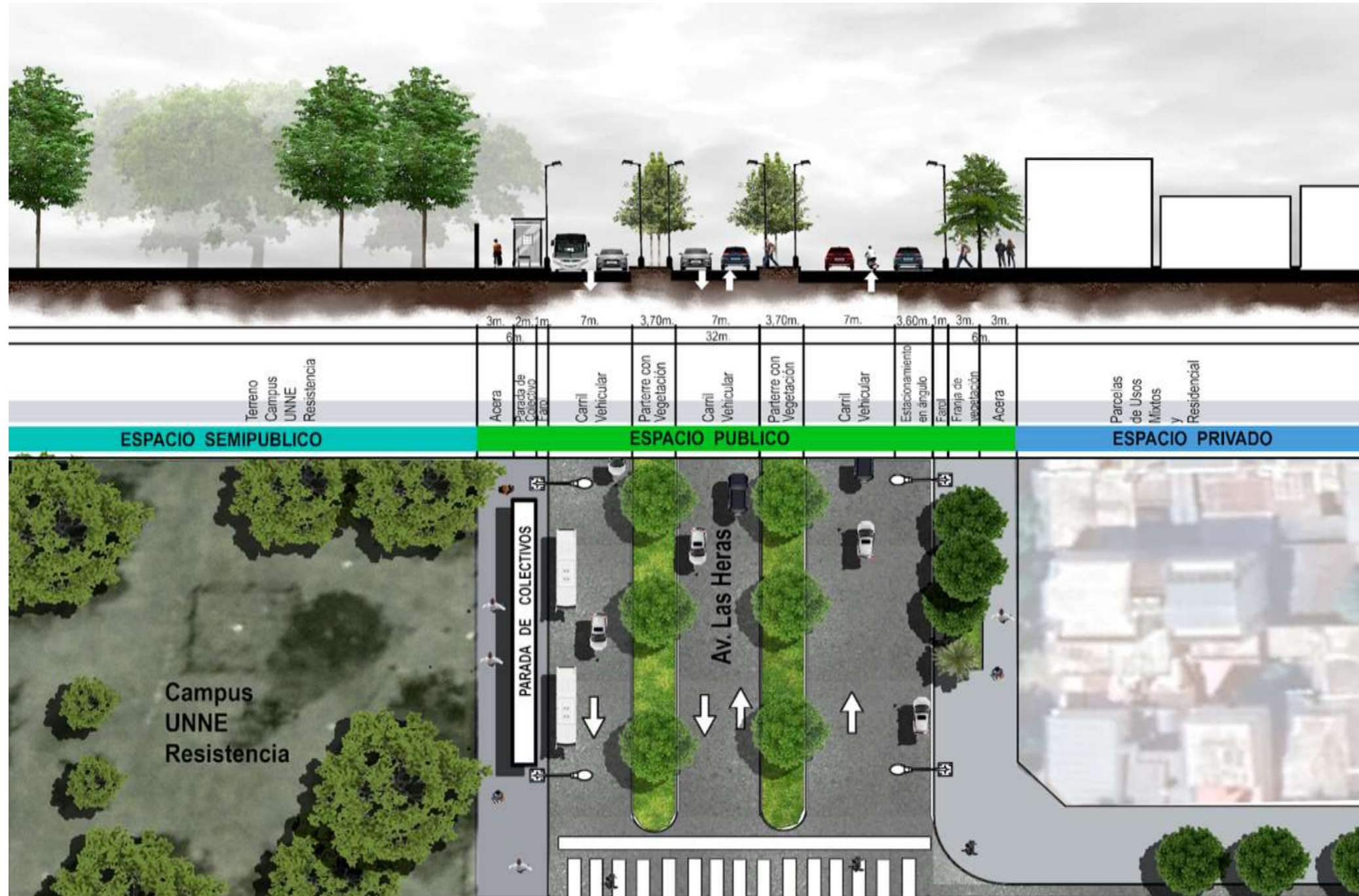
(Figura 58 ): Planta AMPLIACIÓN 01 y Corte Perfil A-A de la situación actual de la Avenida Las Heras. Fuente: Elaboración Propia.
