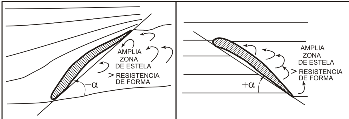
FIGURA 49a | Perfil alar con -\alpha relativamente grande
