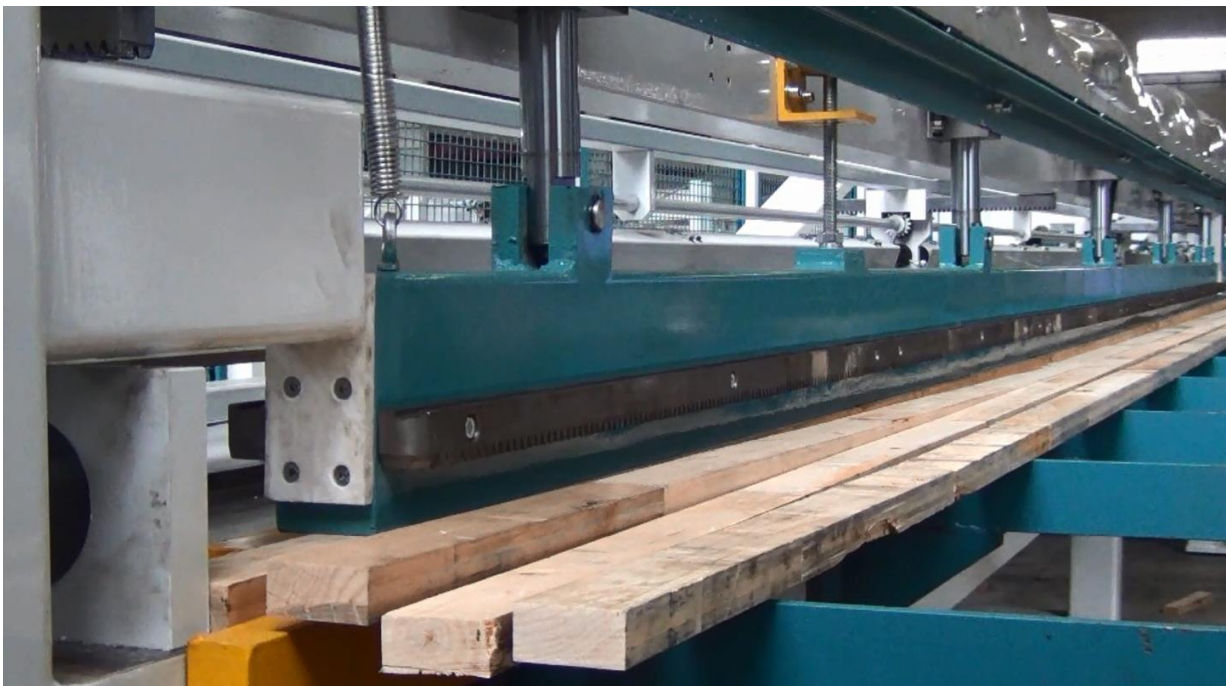
Prensado hidráulico de cabeza con contención de la madera en 4 lados.
