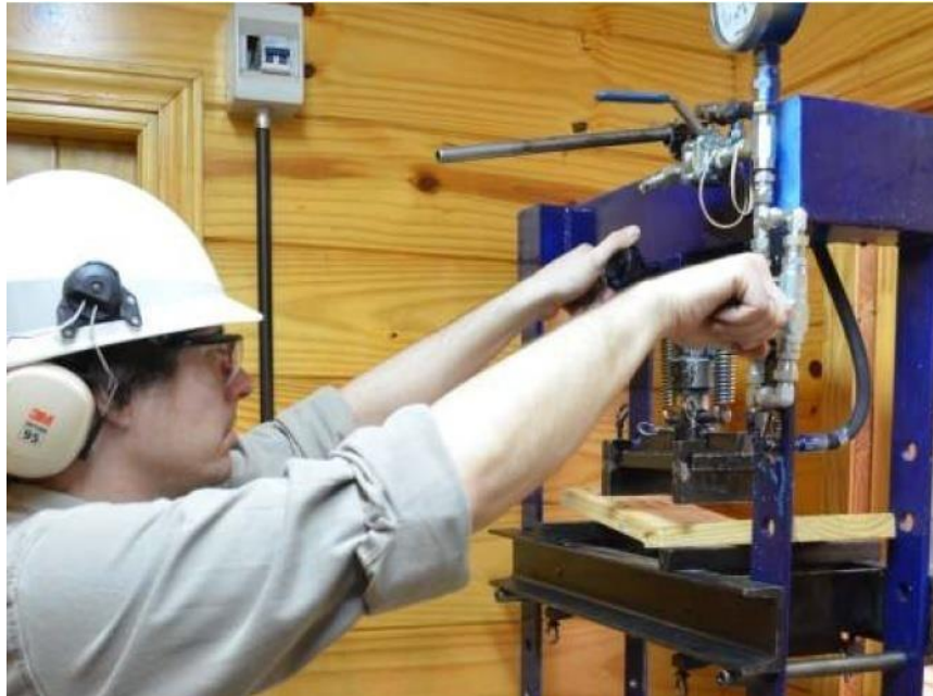
Figura 35. Ensayo de flexión según IRAM 9661. (Fuente: Victoria maderas, 2012)
