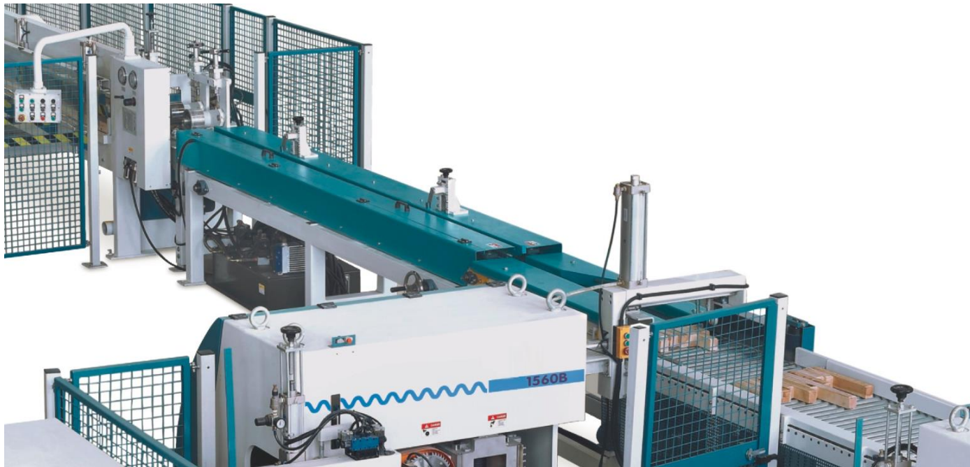
Vista del sistema de transferencia automatico – Pre-juntado a cadenas – y Pre-Juntado a rodillos hidr.
