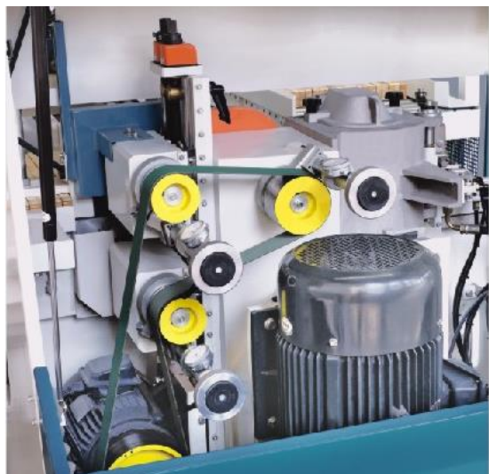
Ajustes con indicadores digitales y insisor sup e inf. Ajuste fino con comparador.
