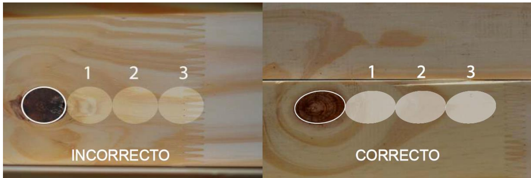
Figura 31. Detalle de distancia mínima de nudos a uniones dentadas según IRAM 9661.
