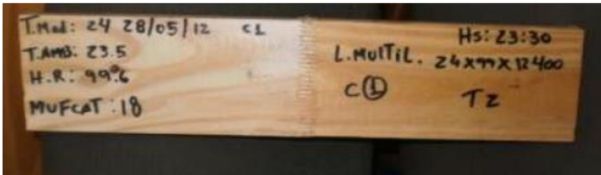
Figura 36. Probeta de unión dentada, con los debidos registros enmarcados en la misma, por ser ensayada a flexión según IRAM 9661. (Fuente: Victoria maderas, 2012)
