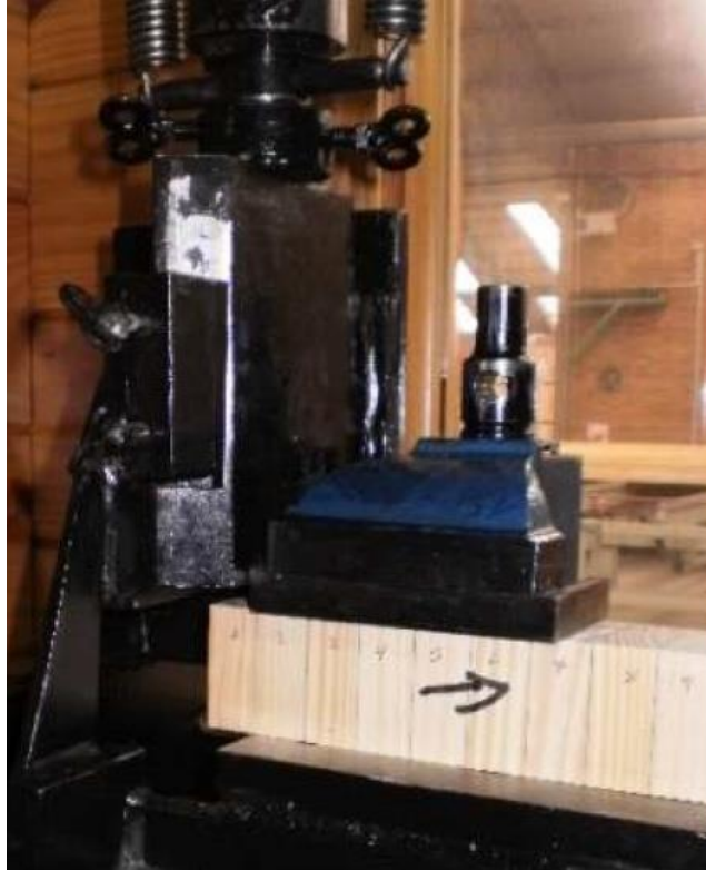
Figura 37. Ensayo de cizallamiento según IRAM 9660-2. (Fuente: Victoria maderas, 2012)
