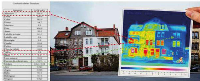
Fig. 3: La conductividad térmica del material define la resistencia térmica de la envolvente constructiva del edificio. Fuente: JACOBO, G., 2016-22.
