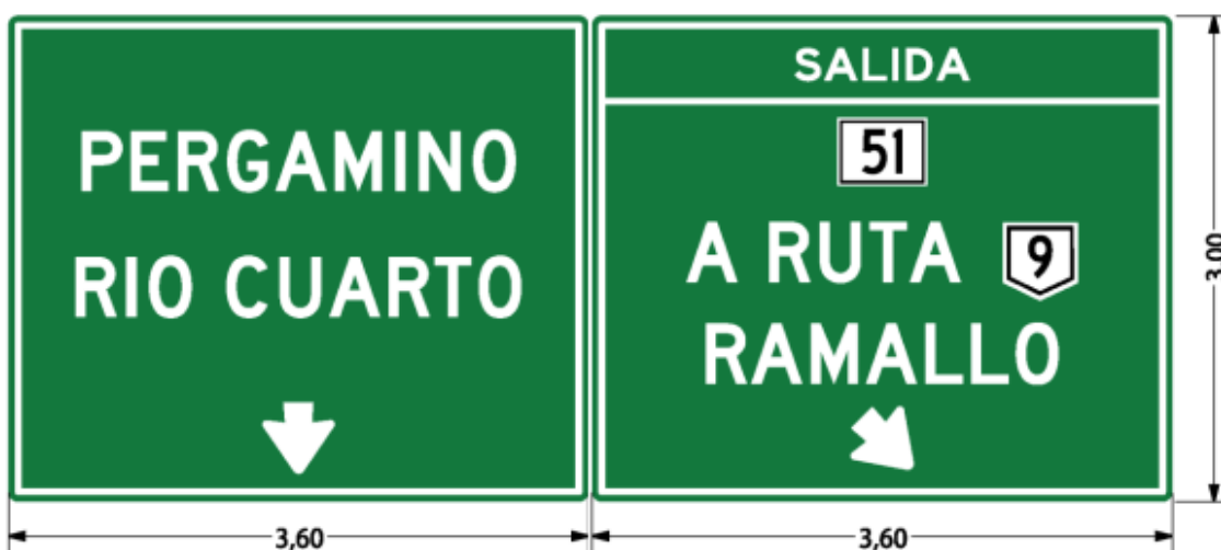
Figura 10.1.1.1.3 - Cartel señalizador de salida de la autovía. - Fuente: Manuales y Normas de la Dirección Nacional de Vialidad.
