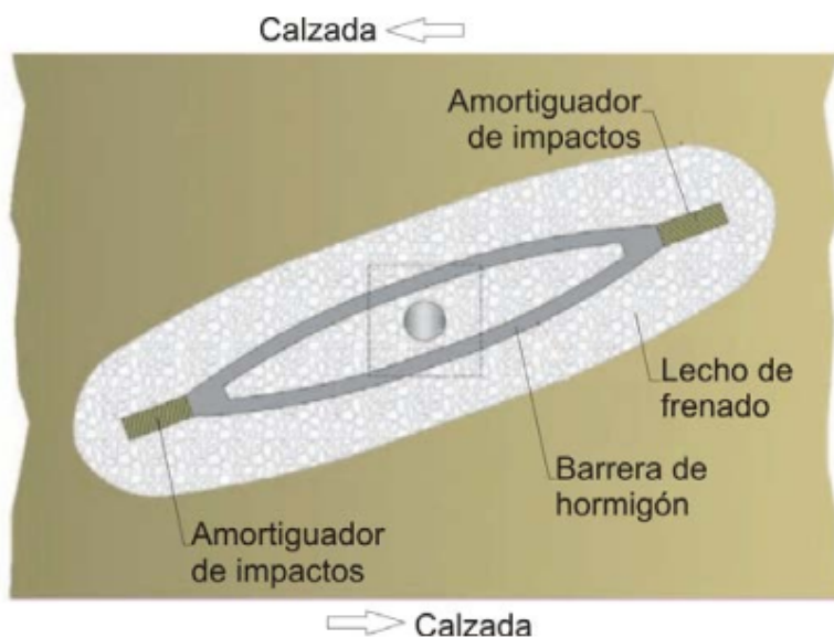
Figura 10.1.3.2 - Vista en planta de protecciones en pila.
