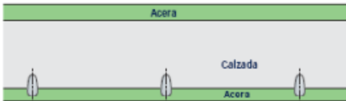
Figura 10.1.2.3.6: Distribución unilateral de luminarias
