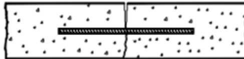
Figura 51. Junta longitudinal de contracción con barra de unión. (Fuente: Instituto del Cemento Portland Argentino).
