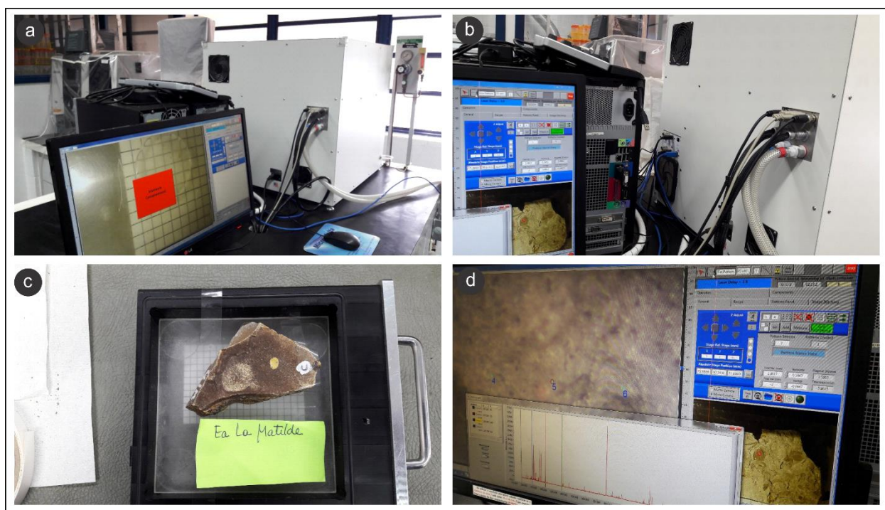
Figura 11: a-b) Equipamiento LIBS. c) Portamuestra LIBS. d) Visualización de los puntos medidos, obtención de los espectros LIBS.
