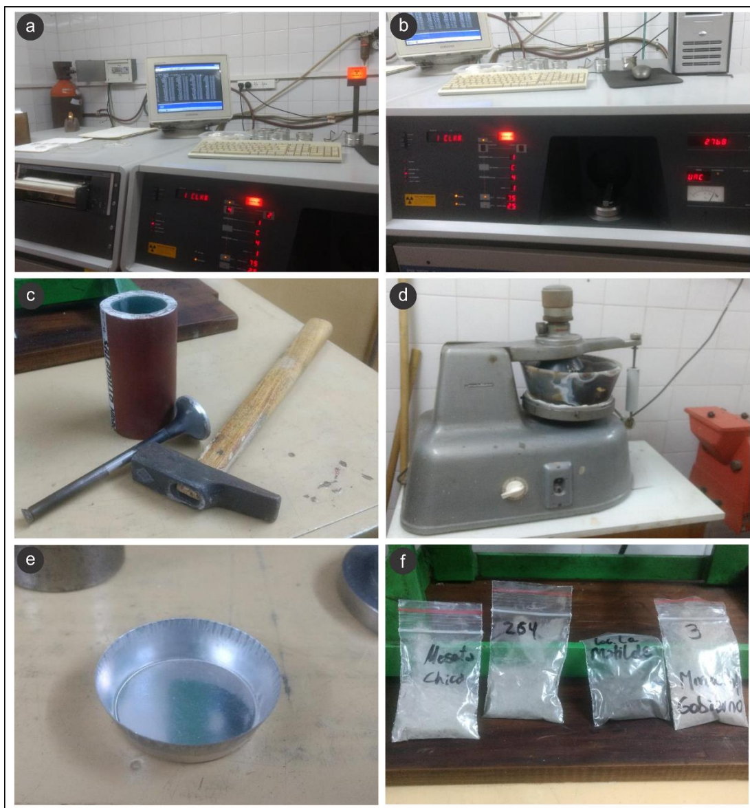
Figura 8: a-b) Espectrómetro de rayos X Philips PW 1400 – WDS. c) Martillo y cortahierro para reducción de tamaño de las muestras. d) Molino de mortero de ágata. e) Disco para pesar las submuestras pulverizadas. f) Submuestras en polvo de algunas de las localidades estudiadas.
