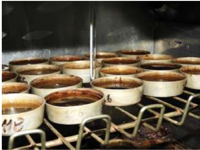
Foto N° 9: Estufa, detalle de pesa-filtros
