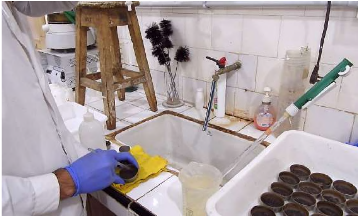
Foto N° 10: Agitado de la solución luego de agregar NaOH 0,05N, con la ayuda de una varilla de vidrio.
