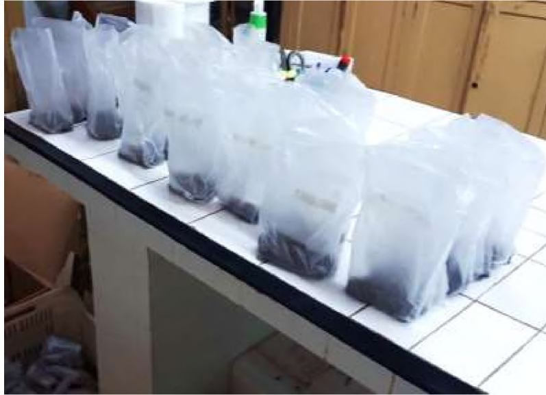
Foto N° 4: Muestras de suelo secas al aire, molidas y tamizadas, conservadas en bolsas plásticas
