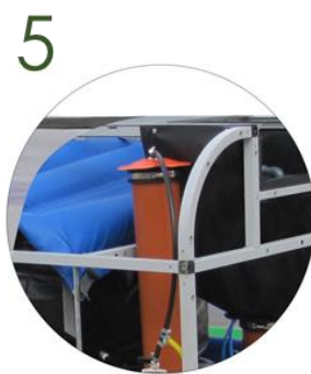
5 FILTRO DE GAS ACTIVO
