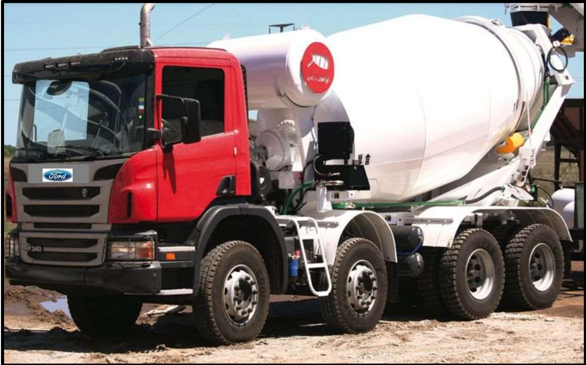
Figura 20. Camión mixer (fuente: Indumix S.A.).
