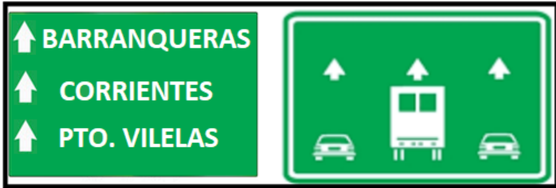
Figura IV.17. Señales aéreas de carril y orientación. (Fuente: elaboración propia)
