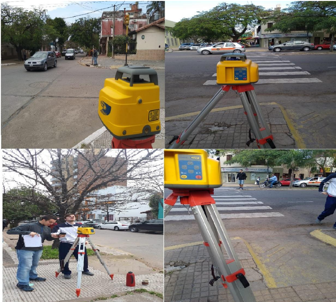
Figura V.5. Relevamiento topográfico con nivel. (Fuente: elaboración propia)
