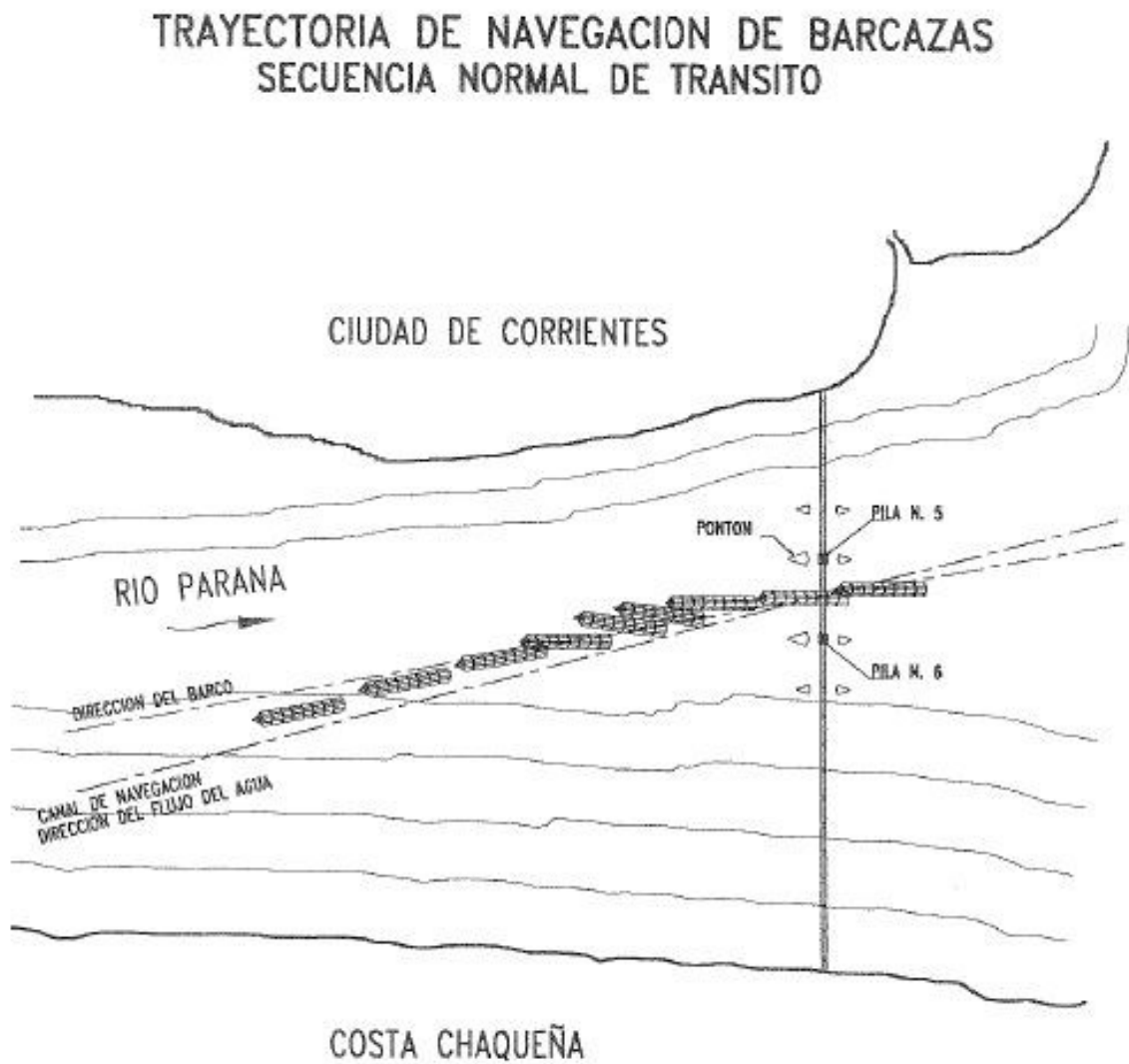
Fig. 18. Imagen de la secuencia normal del tránsito de embarcaciones. (Fuente: Vialidad Nacional )
