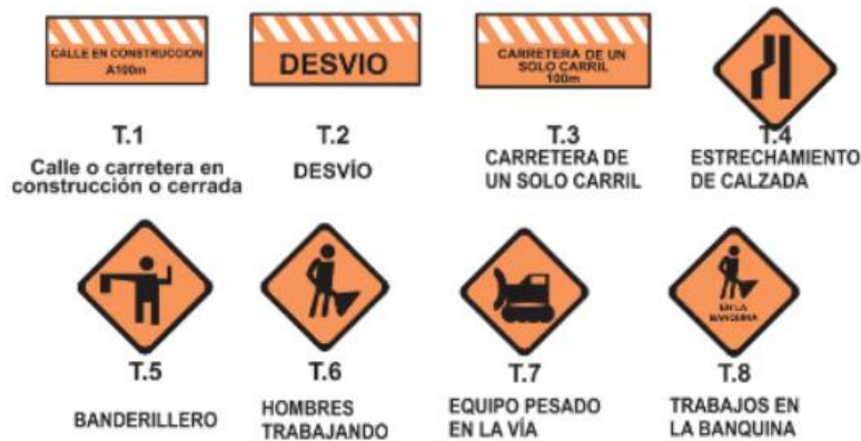
Imagen 8.8: señales transitorias. – (Fuente: DNV- Manual de señalamiento vertical).
