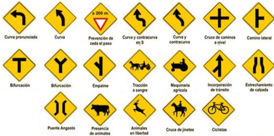
Imagen 8.7: señalamiento vertical de prevención. – (Fuente: DNV- Manual de señalamiento vertical).
