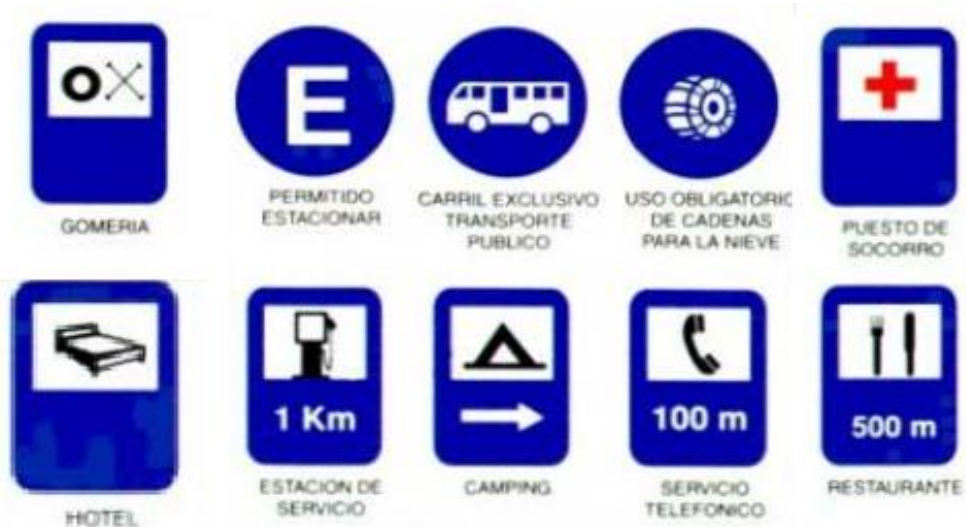
Imagen 8.10: señales de información. – (Fuente: DNV- Manual de señalamiento vertical).
