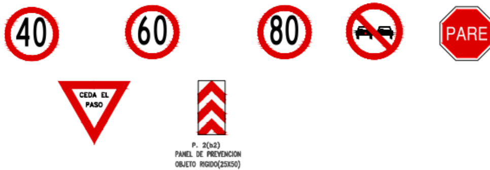
Imagen 8.9: señales reglamentación/restricción. – (Fuente: DNV- Manual de señalamiento vertical).
