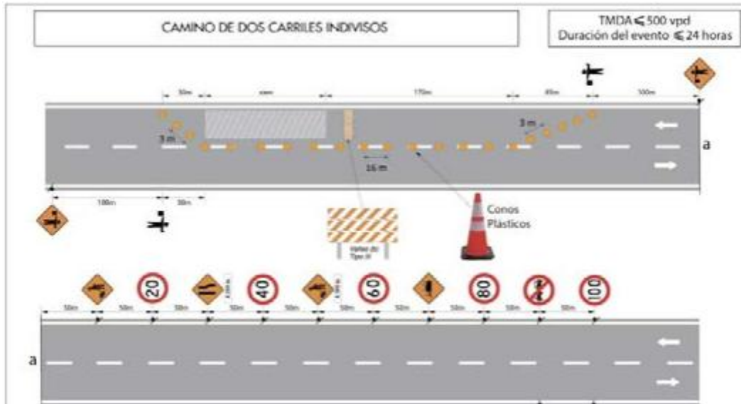
Imagen 8.11: esquema para caminos con TMDA<500. – (Fuente: DNV- Manual de señalamiento vertical).
