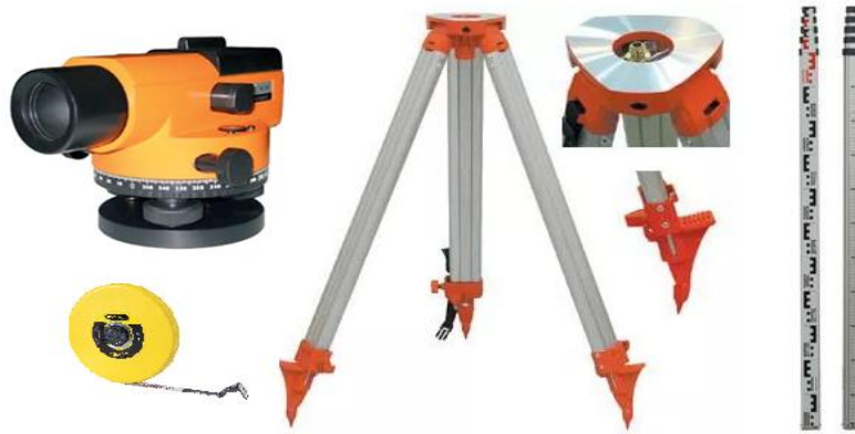
Figura 3.2. Elementos para medición alimétrica. Nivel óptico BOIF, trípode, regla y cinta métrica con alcance de 30 m. (Fuente: elaboración propia.)
