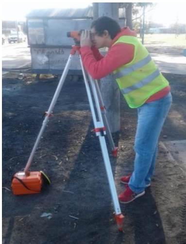
Figura 3.3. Nivelación de puntos. (Fuente: elaboración propia.)
