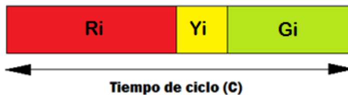
Figura 6.15. Tiempos de reparto y duración del ciclo en semáforo. (Fuente: elaboración propia).
