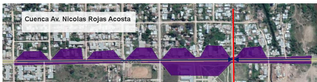
Figura 7.7. Esquema de límites de microcuenca Av. Nicolas Rojas Acosta. (Fuente: Google Earth 2.014 - elaboración propia.)
