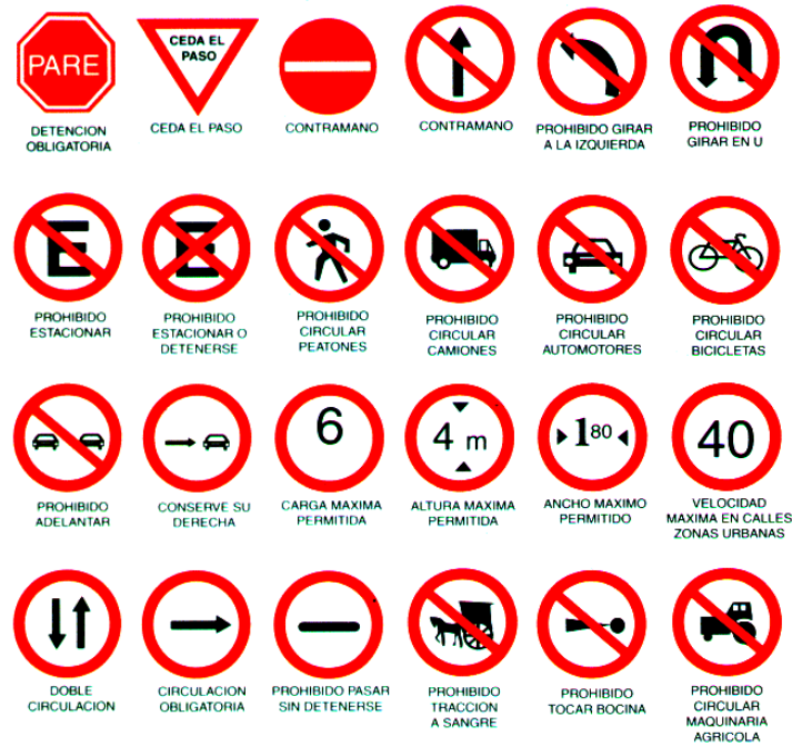
Figura 6.1. Señales reglamentarias. (Fuente: Vialidad provincial del Chaco.)
