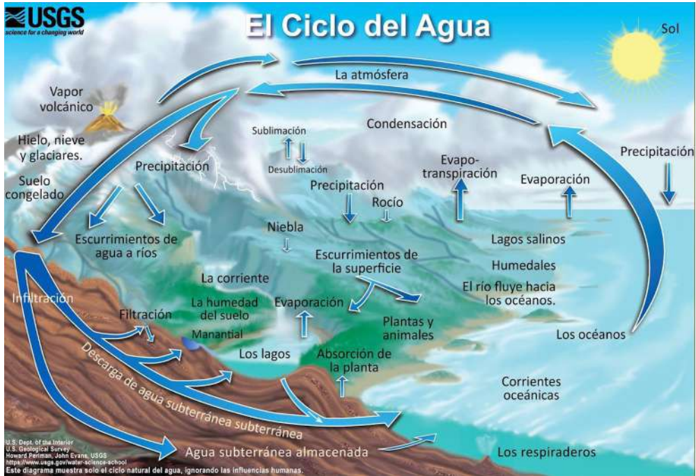
Figura 10. Ciclo del agua. La radiación solar suministra energía para la evaporación del agua; el vapor de agua que circula en la atmósfera cae a través de la precipitación , una parte cae directamente sobre el suelo y sobre las masas de agua, otra es interceptada por la vegetación, por la materia orgánica muerta del suelo y por las estructuras urbanas y las calles. La precipitación que llega al suelo pasa a la tierra mediante infiltración (figura tomada de Perelman y Evans, 2019, CCo).
