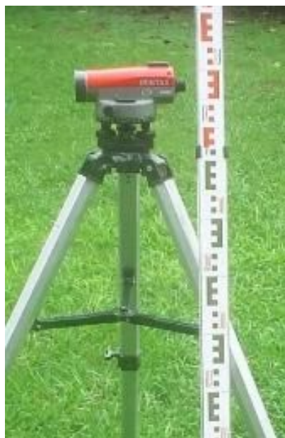
Fotografía 3. Nivelación de Puntos fijos con nivel.
