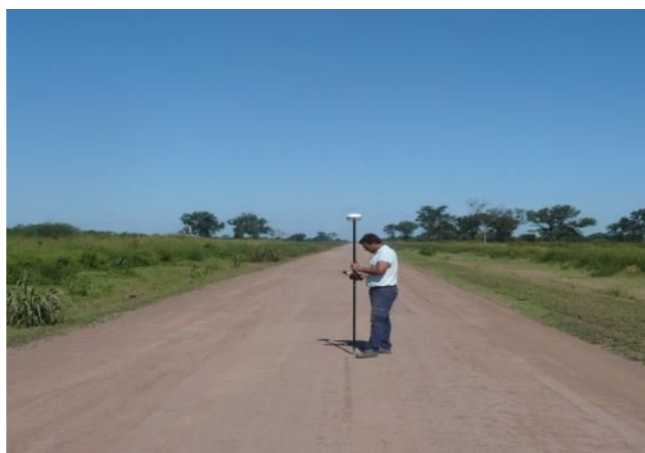
Fotografía 4. Relevamiento topográfico con GPS.
