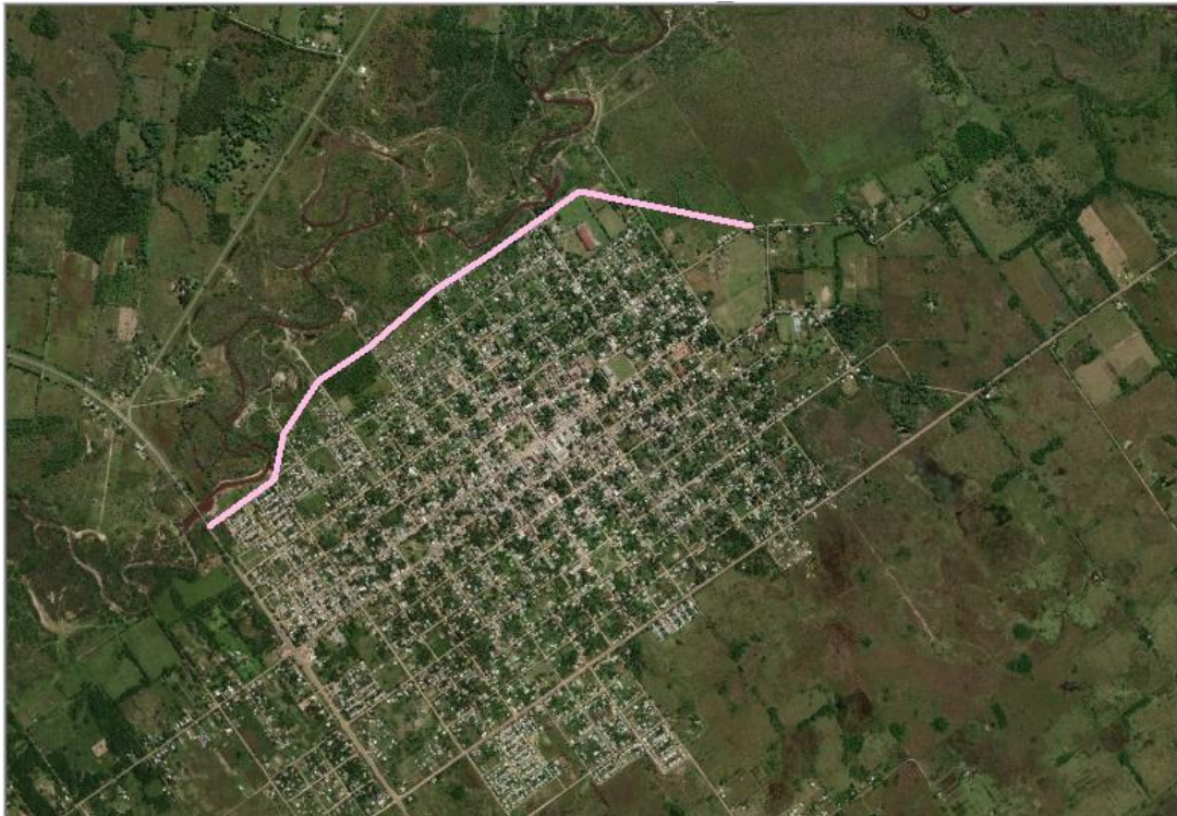
Figura 6.3. Traza de terraplén propuesta. (Fuente: Elaboración propia en base a imágenes de Google earth)
