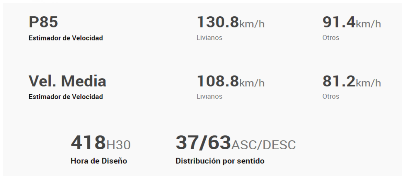
Figura 15: Velocidades medidas en campo con contador automático.
