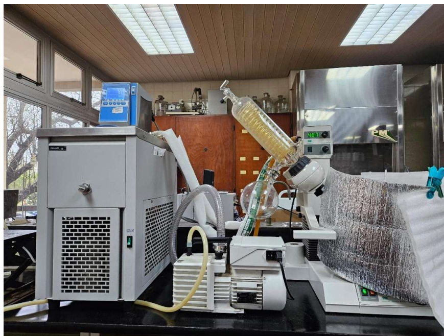
Figura 2.3. Rotavapor Büchi R-124 conectado a refrigerador Arcano® MP-10c conectado a una bomba de vacío.
