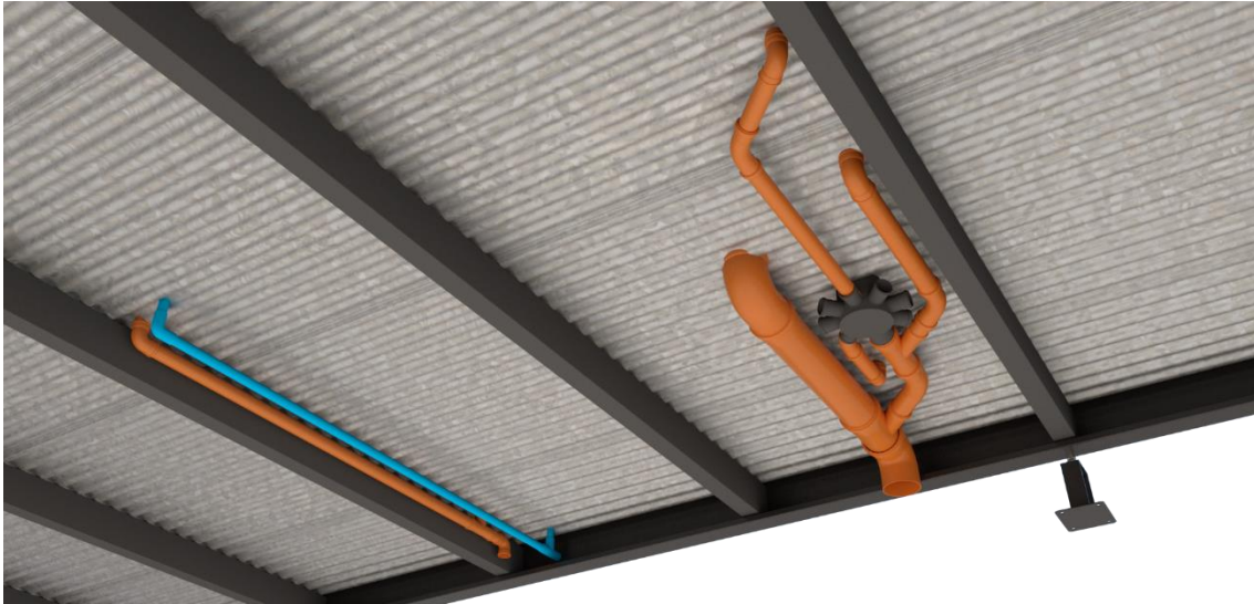
Imagen 25: Vista de las instalaciones prearmadas. Fuente: Elaboración propia.
