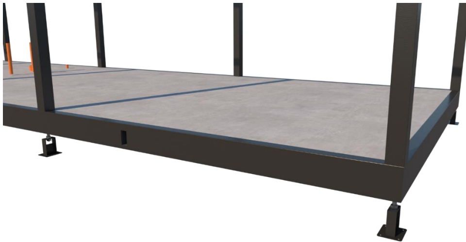
Imagen 26: Estructura del módulo con el contrapiso realizado. Fuente: Elaboración propia.
