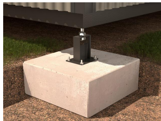
Imagen 34: Vista del apoyo + dado de hormigón. Fuente: Elaboración propia.
