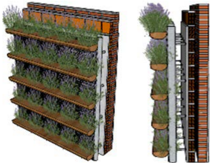
Figura 3. Dispositivo vertical con caños de PVC. Fuente: elaboración propia.
