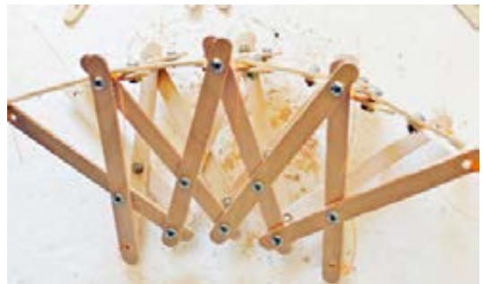
Figuras 1, 2, 3, 4, 5 y 6. Maquetas de estudio de estructuras desplegables. Elaboración propia
