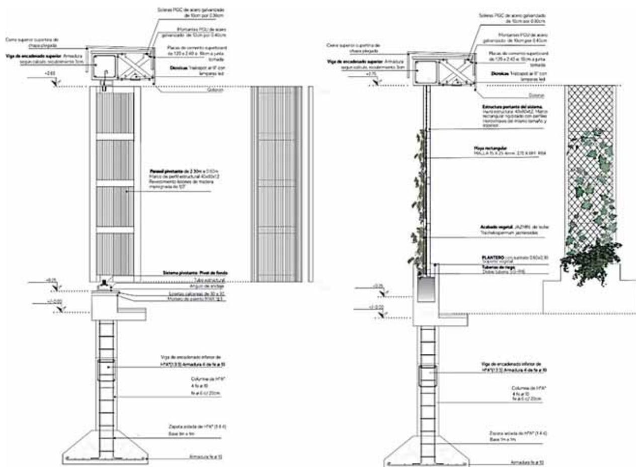
Figura 2. Detalles constructivos de propuesta de parasoles pivotantes y pared verde, de elaboración propia
