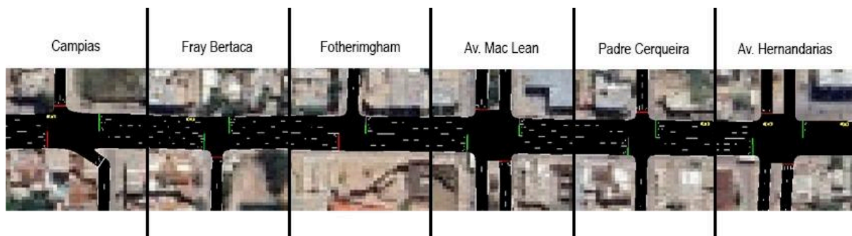
Figura 6.20: Progresión del pelotón vehicular en sentido sur-norte lograda (simulación SUMO). Fuente: Elaboración propia
