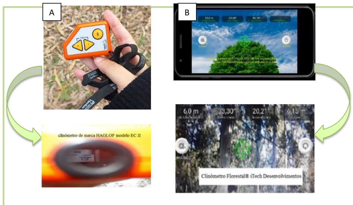
Figura 10. Instrumentos para las mediciones forestales de parámetros de rendimiento de altura. A- Clinómetro digital para mediciones de alturas de los árboles; B- Aplicación Clinômetro Florestal® de Smartphone para mediciones de altura de los árboles.
