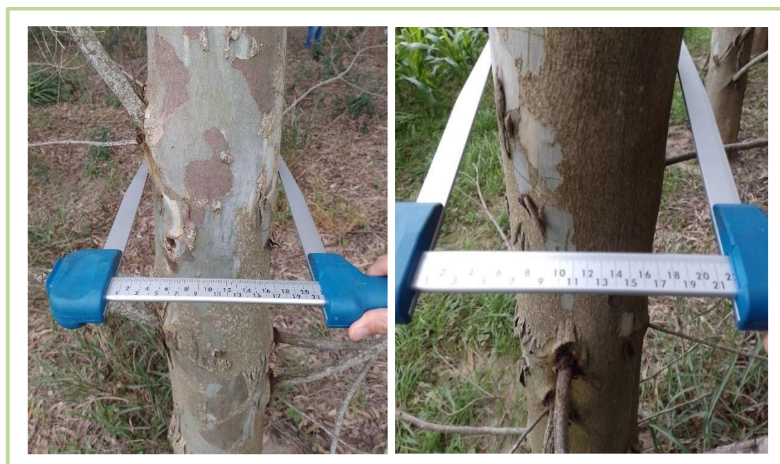
Figura 11. Utilización de forcípula forestal para la medición del diámetro a la altura de pecho (DAP), de los distintos rodales dentro de las parcelas asignadas .
