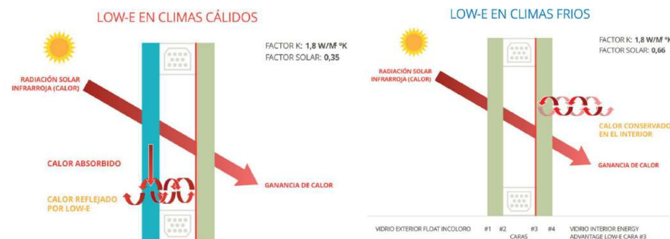
Gráficos: Energy Advantage. (2024) sistema low-e.gráfico.vasa. Low E – VASA
