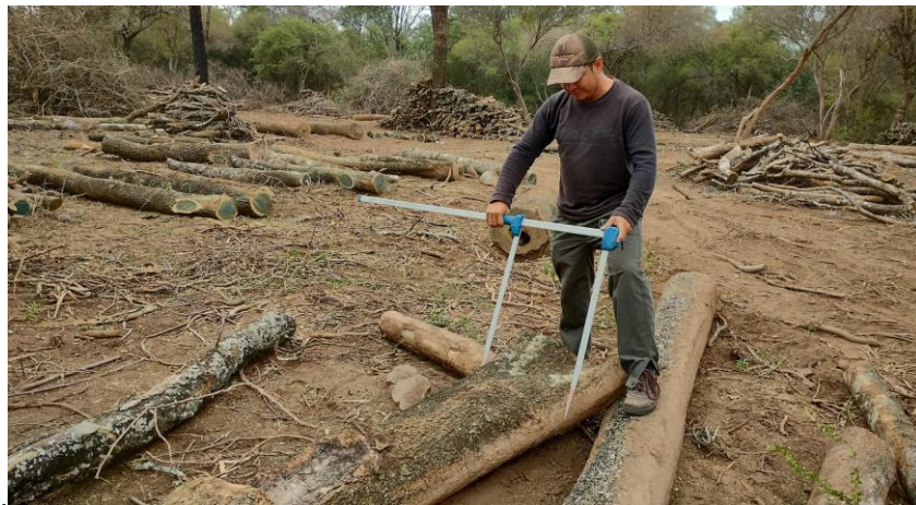
Figura 9. Forcípula y cinta dasométrica, para la medición del diámetro mayor y menor de las trozas, medidas aplicadas en el estudio.
