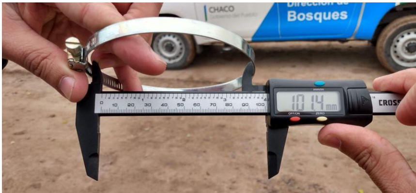
Figura 10. Calibre o Vernier, se utilizó para medir diámetros mínimos que entrarían a torneado, (medida mínima de torneado 100 mm) y productos como tablas teniendo de esta manera mayor precisión en las medidas.
