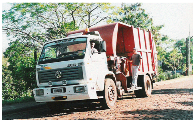
Figura. 7. Camión recolector con caja compactadora de carga lateral.
