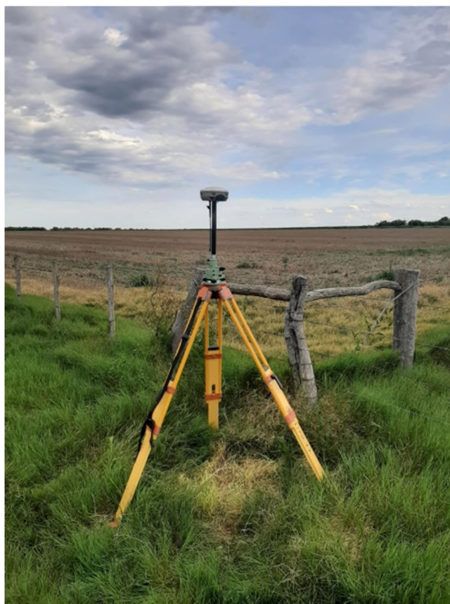
Imagen 18: Receptor base operando sobre mojón en PAF1.
