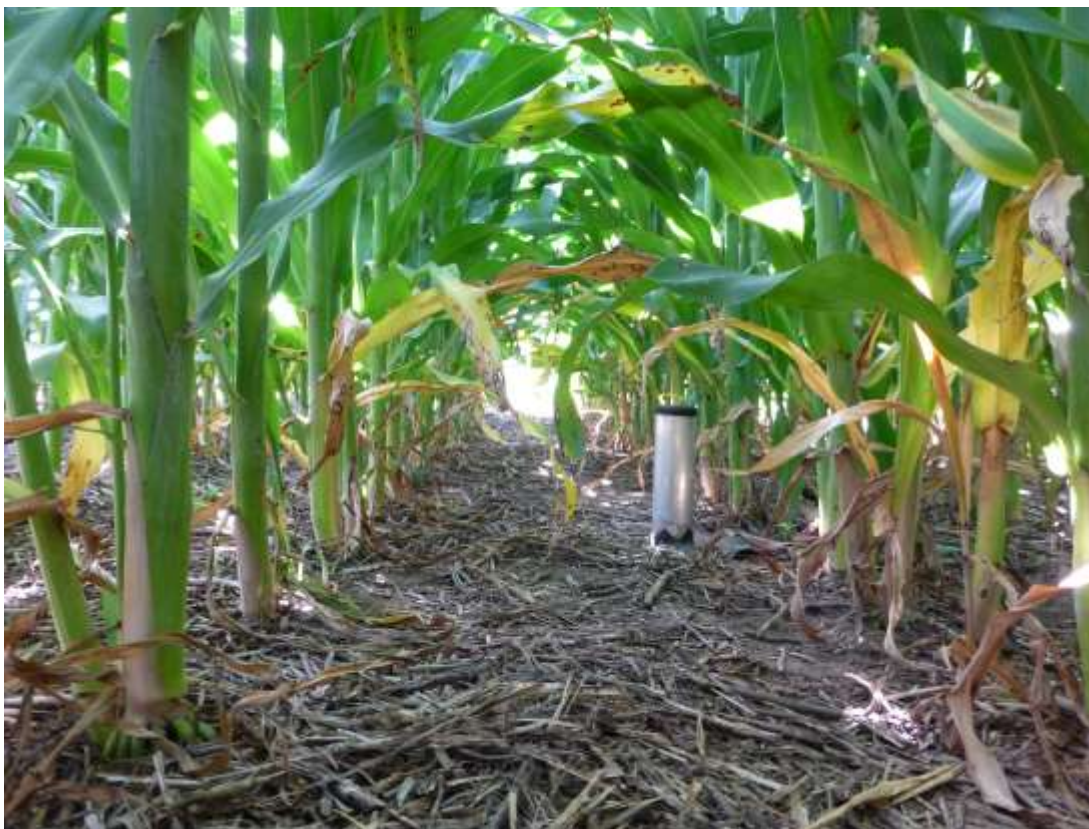
Figura 4: Tubo para medición con sonda de neutrones dispuesto en el entresurco a profundidad de 1,6 metros.
