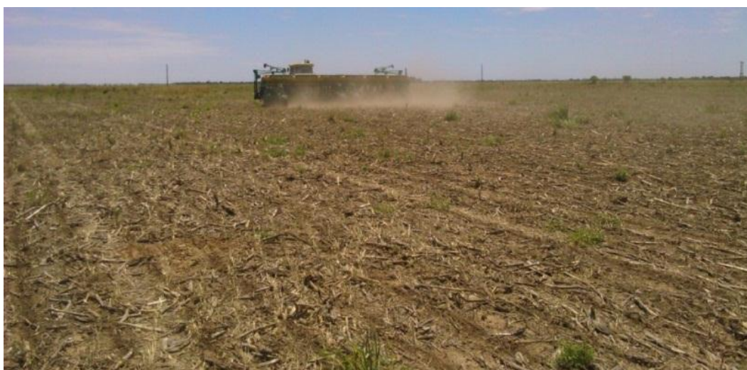
Figura 5. Sembradora ERCA de 21 surcos
