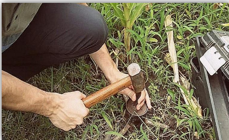
Figura 2: Introducción del cilindro principal con la ayuda de un émbolo y un mazo.
