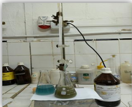
Figura 3: Titulación de las muestras preparadas por el método de Walkley and Black (en los erlenmeyers se observan cambios de colores previos a arribar al punto final).
