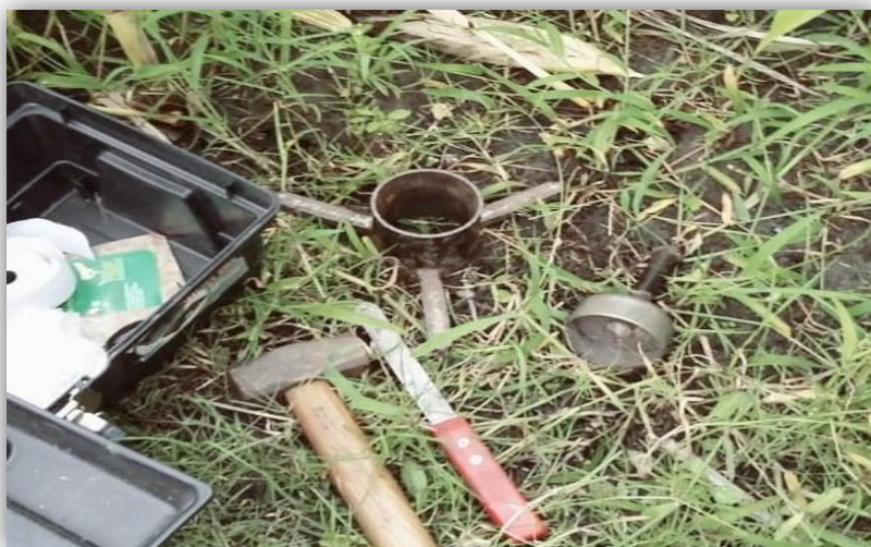
Figura 1: Dispositivo usado como guía para introducir el cilindro principal en forma perpendicular.
