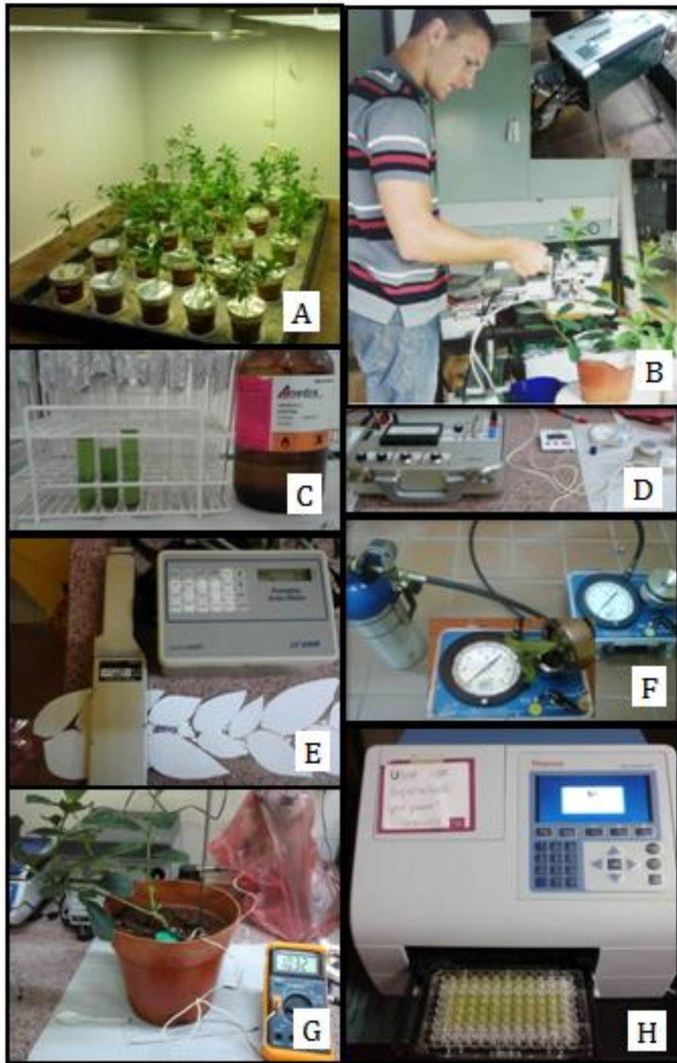
Fig. 1 Materiales utilizados. A) Cámara climatizada con condiciones de luz (PAR: 420 \mu\text{mol}\cdot\text{m}^{-2}\cdot\text{s}^{-1} , fotoperiodo: 12 hs.), temperatura (fotoperiodo/escotoperiodo: 27\pm 2/20\pm 2^\circ\text{C} ) y humedad relativa (50-55%) controladas. B) Medidor de fotosíntesis portable marca LiCor modelo Li-6400. C) Extracto de clorofila en fase de acetona. D) Psicrómetro marca Wescor, provisto de una termocupla modelo C-52 para la determinación del potencial osmótico. E) Medidor de área foliar portátil marca LiCor, modelo: Li-3000. F) Bomba Scholander marca PMS, modelo PMS-1000 utilizada para las mediciones del potencial hídrico de la planta. G) Medición de Capacitancia para estimación de la masa radicular. H) Espectrofotómetro marca Multiskan GO, versión: 10040,0000. Utilizado para la determinación de clorofila.
