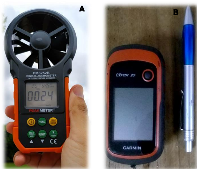
Figura N° 10: Instrumentos utilizados para medir temperatura-humedad y ubicación. A: Anemómetro digital multifunción, B: Sistema americano de navegación y localización mediante satélite-GPS.
